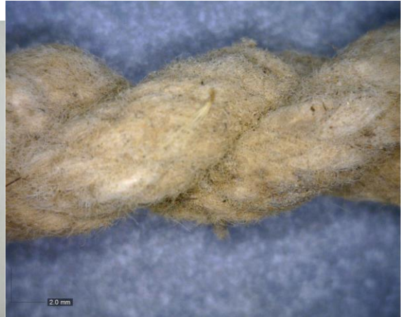
Ply Configuration of 06-019-042-A
