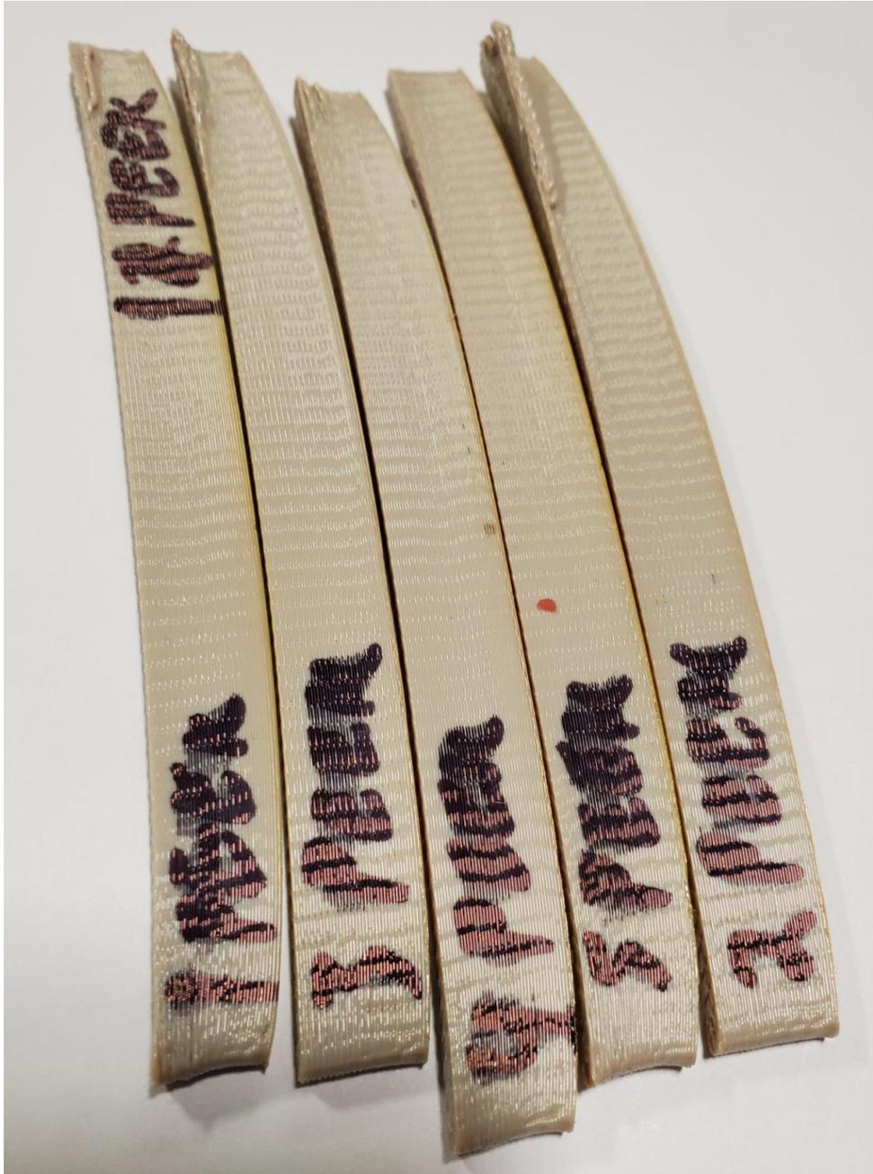
*Figure 176. PEEK on Edge (XZ) Flexural Specimens*
